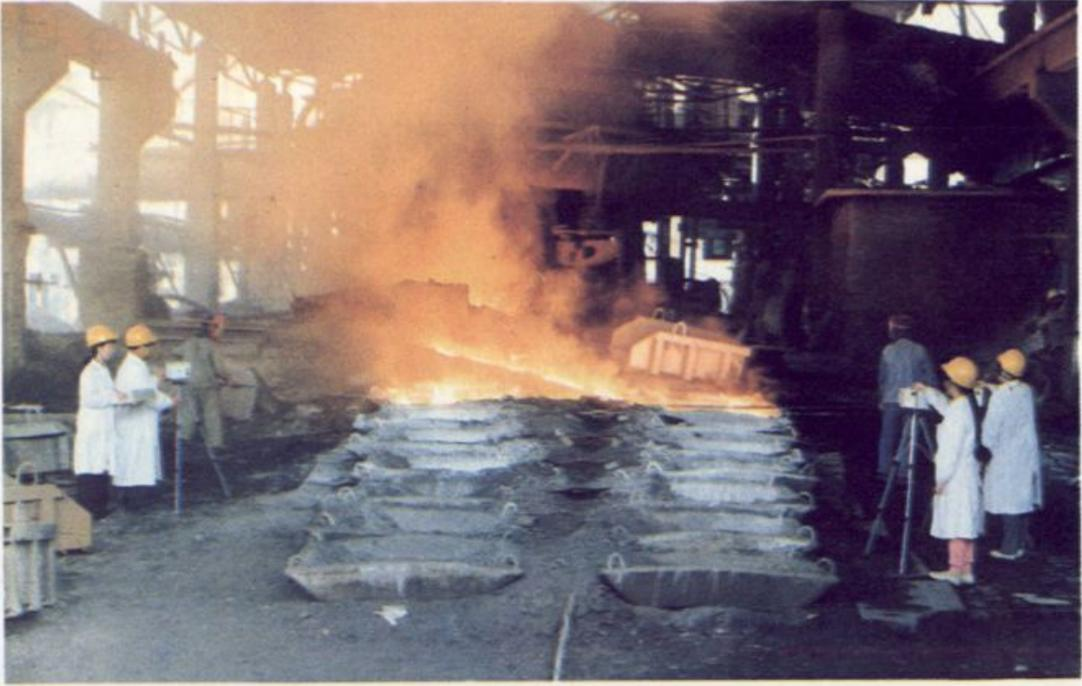
劳动卫生科对锰铁冶炼车间空气中锰蒸气进行监测
