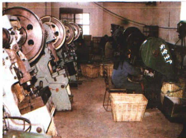
■ 上海光明灯头厂引进设备 SZ-23040t自动冲压机
