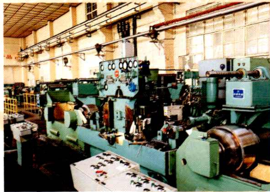
1990年，大连钢厂投产的精密合金20辊冷轧机组
