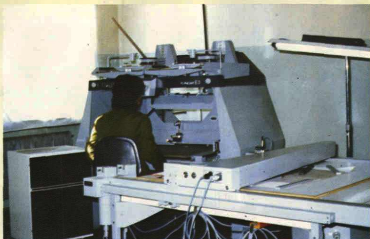
自治区测绘局 测绘人员正在E3测 图仪上作业
