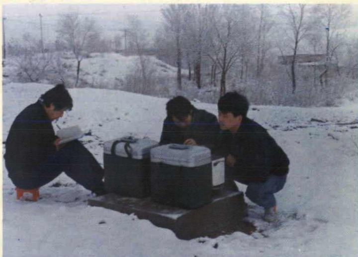
自治区地震局在用 LCR-G 型重力仪进行地震重力观测
