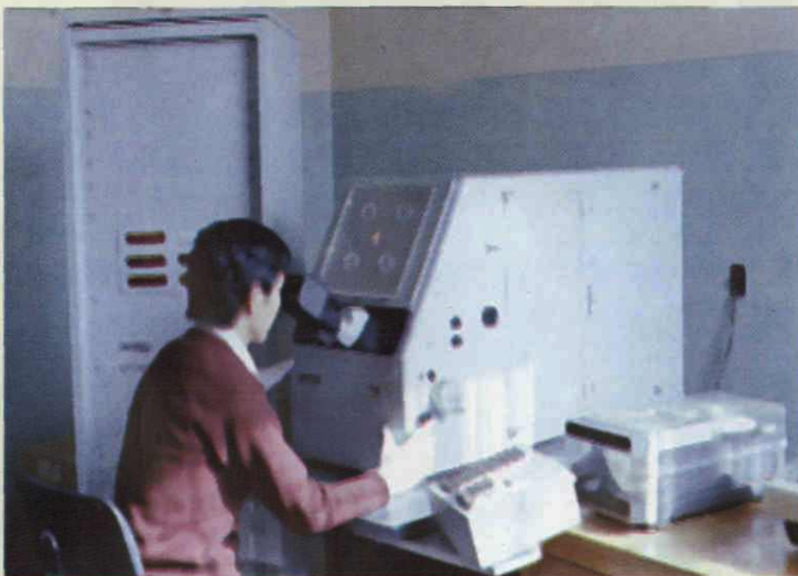
自治区测绘局测 绘人员在用PSK-2坐 标量测仪进行像点观 测
