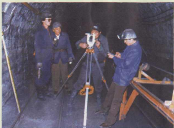
汝箕沟煤矿测量人员在测量井下导线
