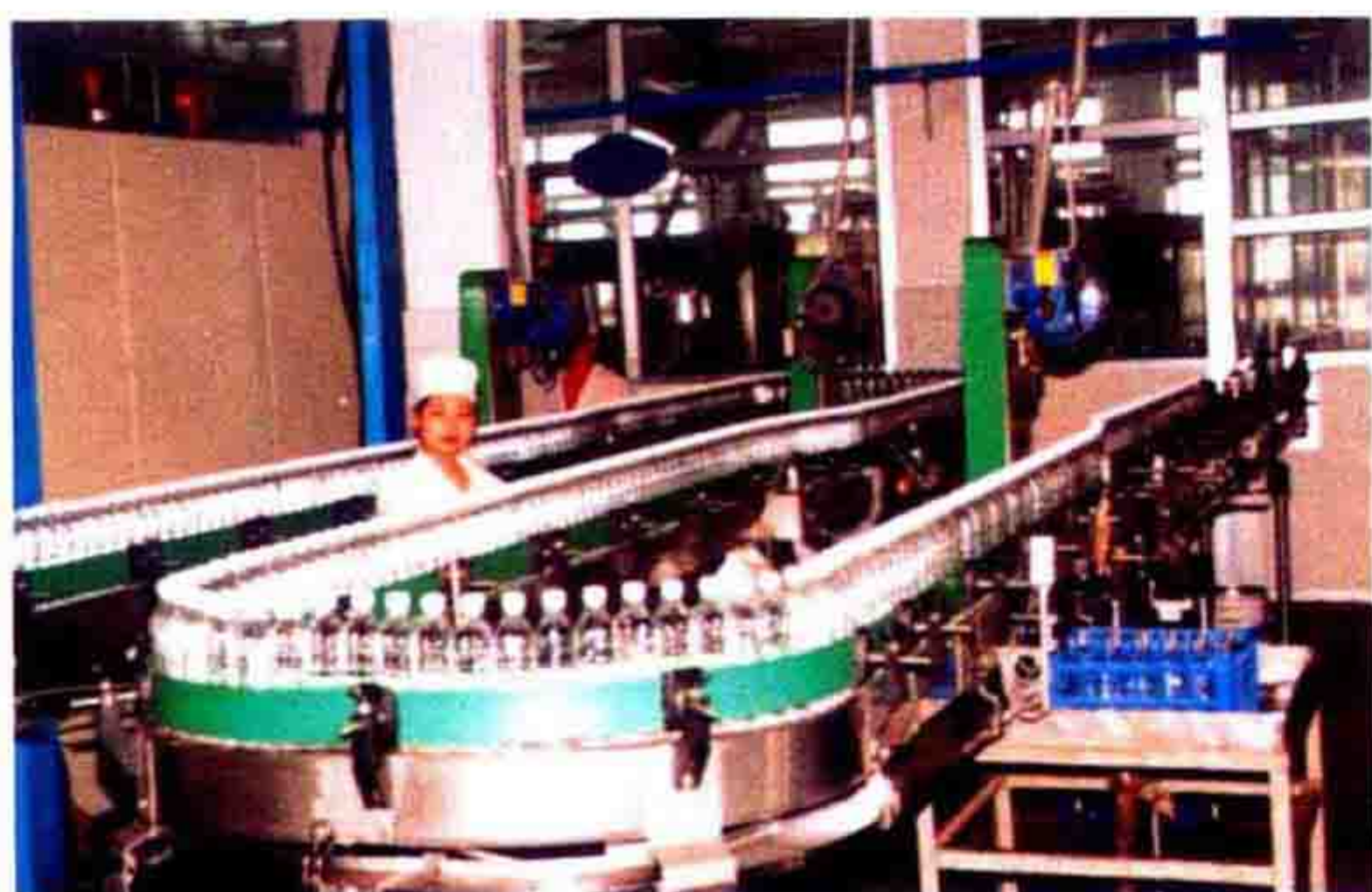
娃哈哈涪陵分公司引进的全自动 纯净水生产线(娃哈哈涪陵分公司提供)
