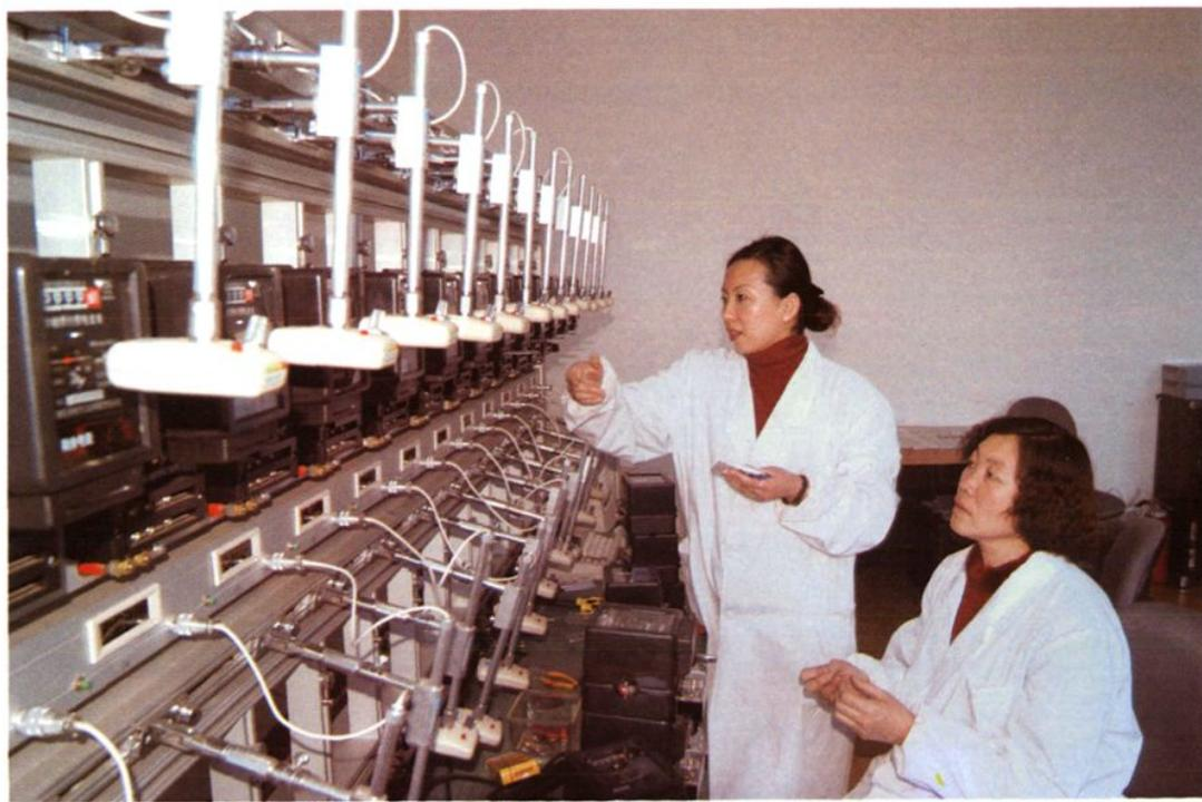
电能计量所工作人员正在校验电能计量表
