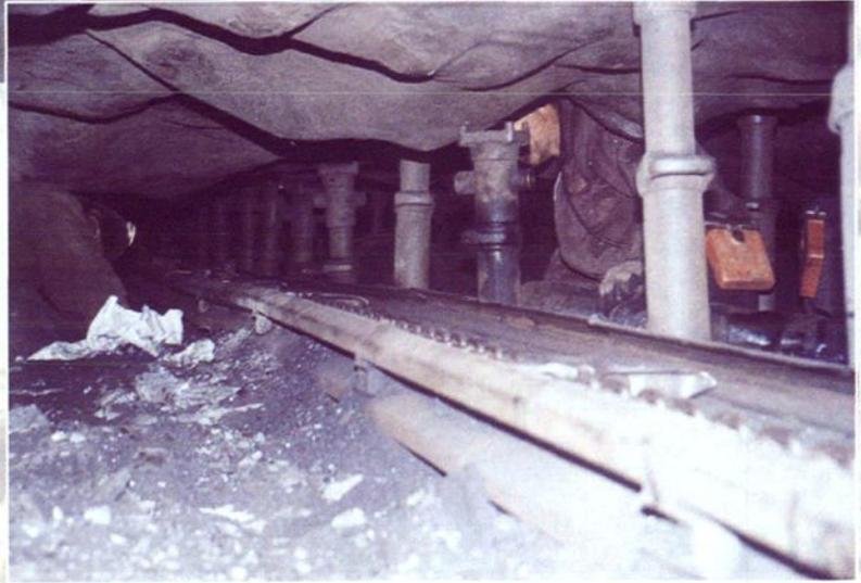
0.3 ~ 0.9 米薄煤层采煤工作面金属液压支架
