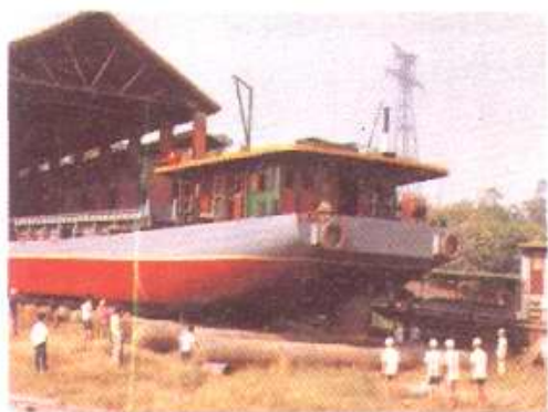
泸州船厂采用气囊上下墩
