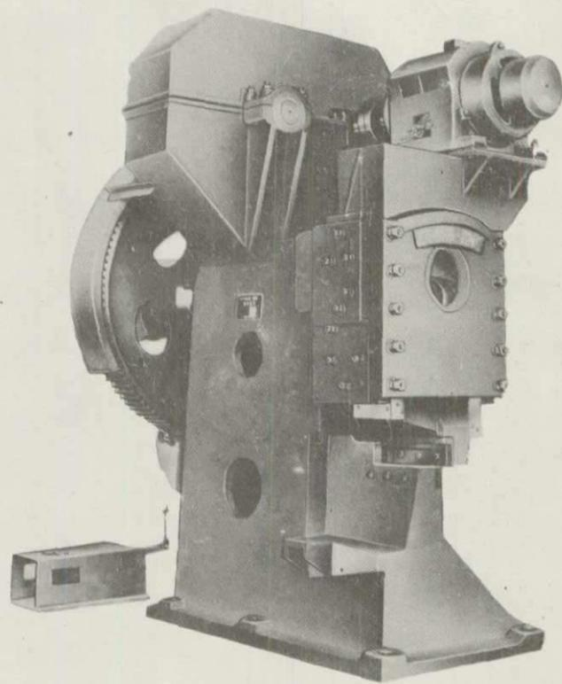
工厂产品 160吨冷、热剪机
