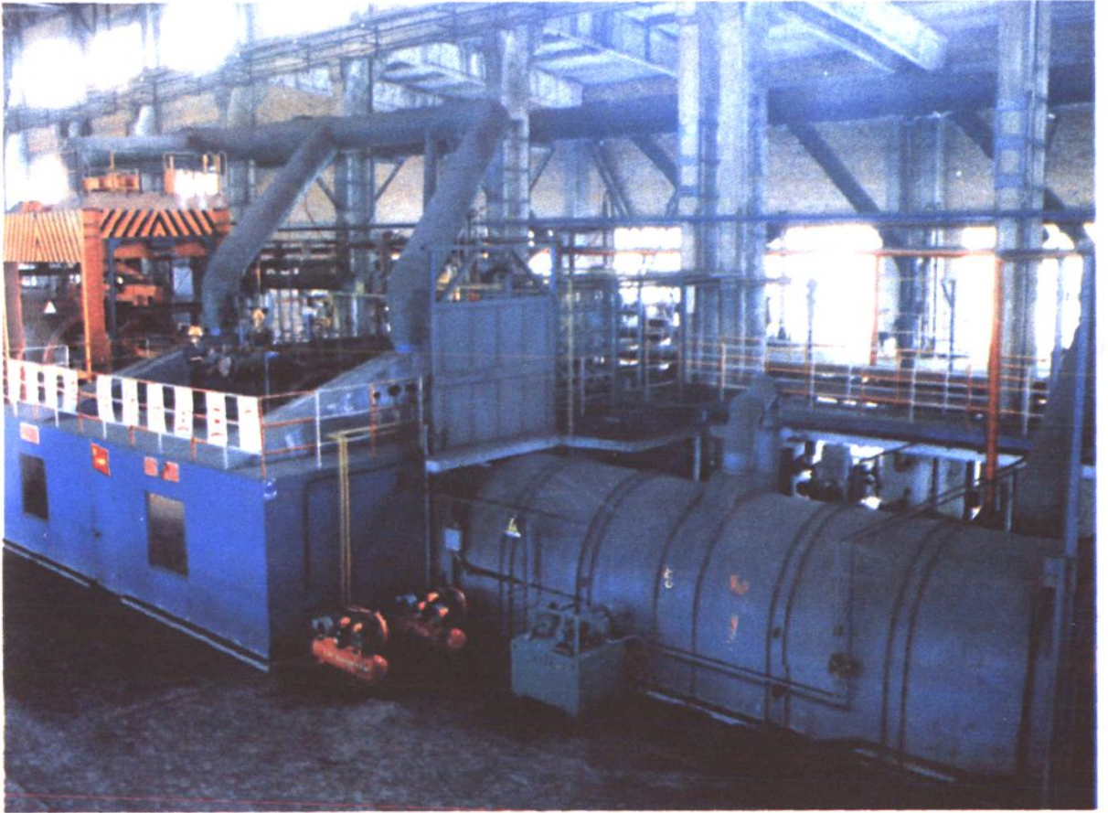
高压浸渍罐是生产高功率和超高功率电极的配套设备，它的投入使用，标志着石墨电极的质量将跃上一个新的台阶。
