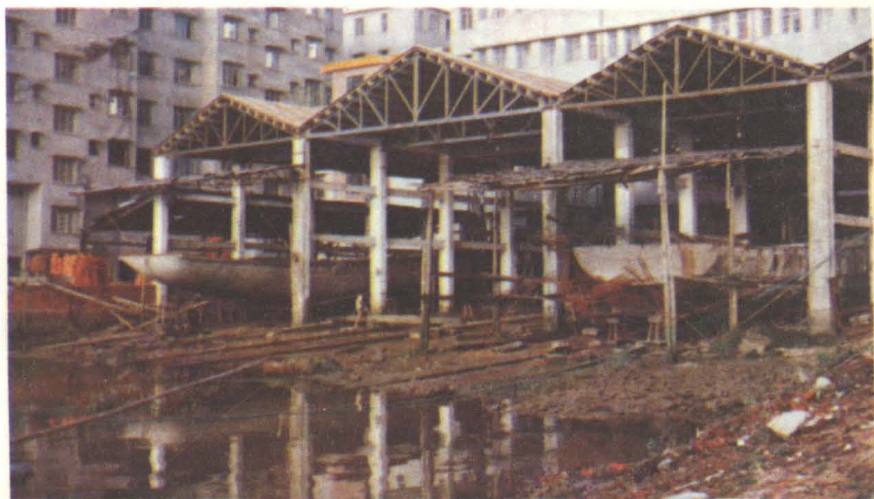
开平县水运公司水泥造船厂正在制造水泥船。
