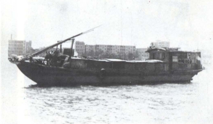
开平县水运公司水泥造船厂制造的水泥丝网材质的船舶。
