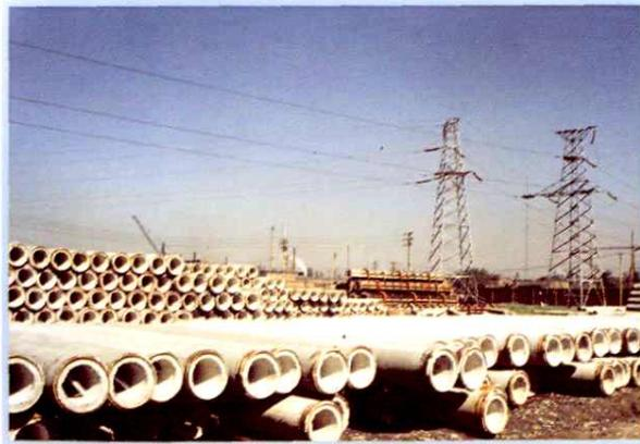
公司生产的 $\phi 300$ — $\phi 400$  预应力电杆填补了自治区空白
