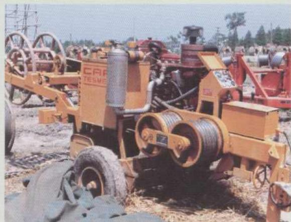
500 千伏输电线路施工采用进口牵张设备架线
