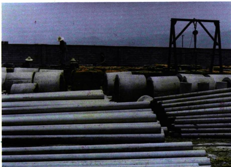
廿二、义乌市水泥制品厂（城阳排灌站）生产电线杆、涵管、多孔板等预制品，采用蒸气养护，规格齐全。
