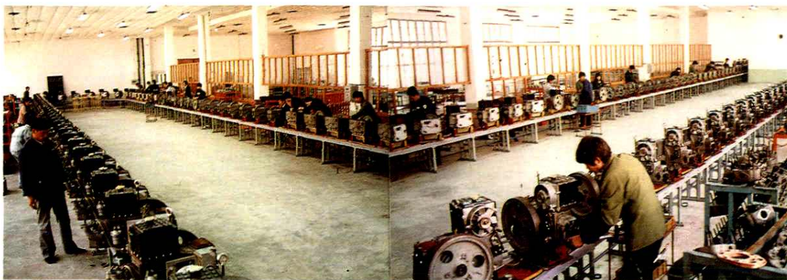
浙江四方集团公司柴油机装配线
