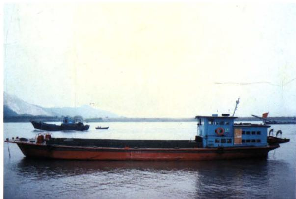
佛冈县水运公司委托清远下廊船厂于90年代初期修造的钢质船—粤清运货8301号（原佛冈机011号），吨位89吨，马力36.7千瓦
