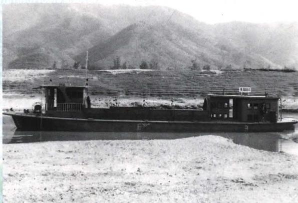
佛冈县水运公司船舶修造厂于80年代中期修造的全钢质船—佛冈机004号，吨位40吨，马力29.4千瓦
