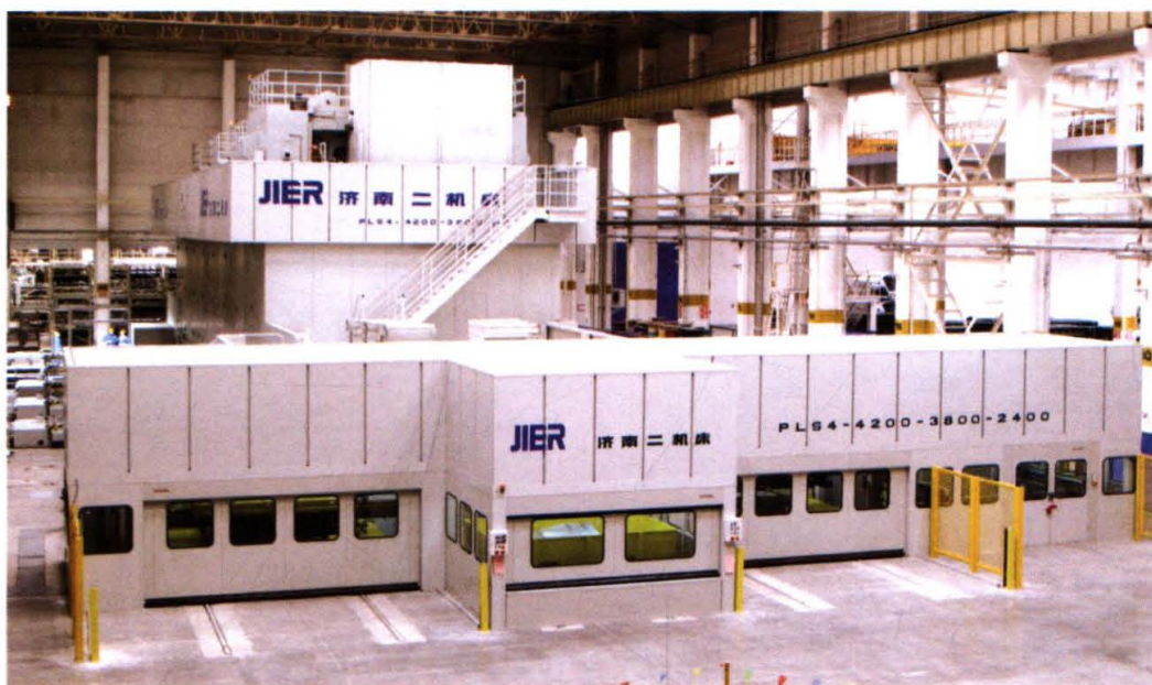
◎ 国家科技重大专项——济南二机床集团为上汽通用汽车公司生产的全自动大型快速双臂冲压线（2009年12月）
