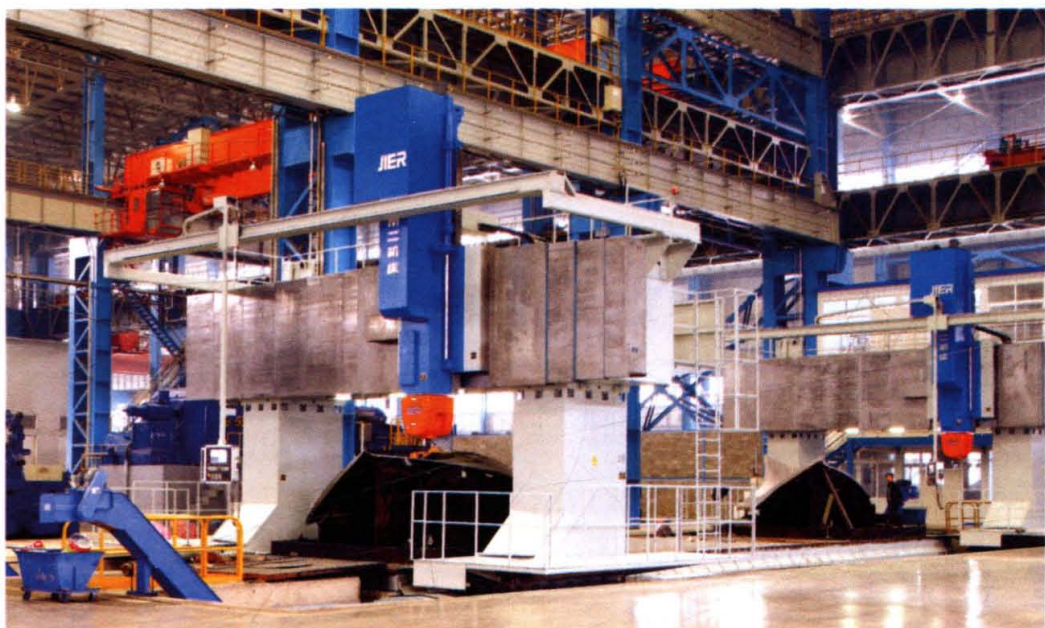
◎ 获中国机械工业科技进步一等奖——济南二机床集团为鞍钢生产的XKV2745双龙门机械五轴联动数控镗铣床（2009年4月）
