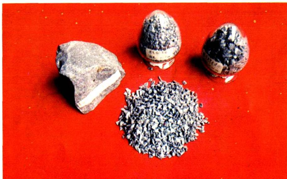
西北耐火材料厂生产的致密性电熔刚玉砂，1989年获国家发明专利。
