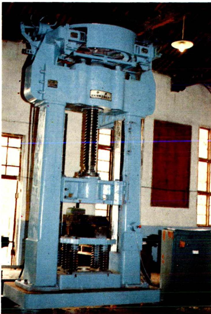
西北耐火材料厂生产的160吨高冲程无接触传动电磁螺旋压砖机，获国家发明四等奖。
