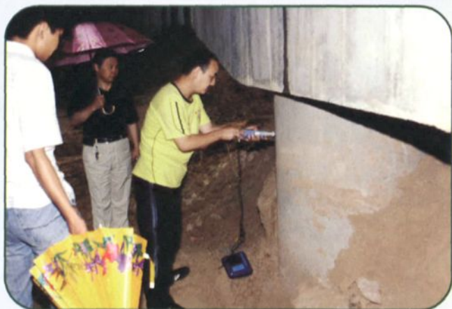
检查组技术人员用仪器检测桥梁混凝土保护层厚度（左图）和强度（右图）
