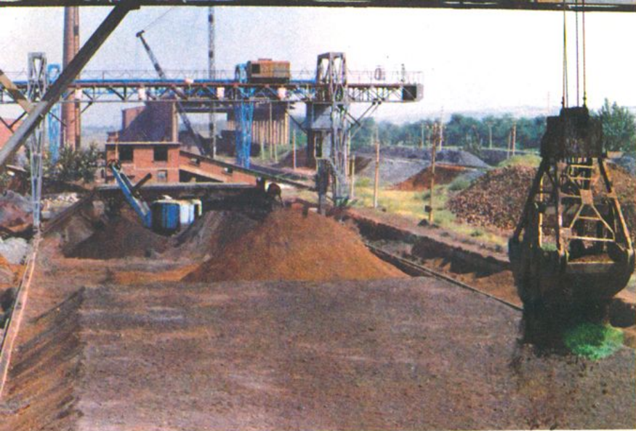
← 采用机械化对原料进行 混匀配料平铺切取
