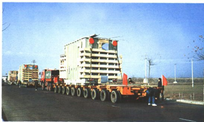
500 千伏 75 万千伏安变压器运输
