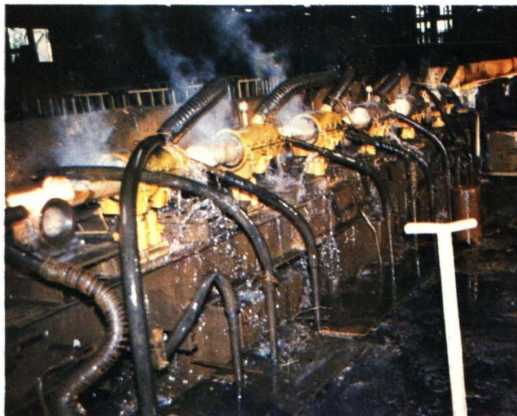
钢管连续控制冷却装置
