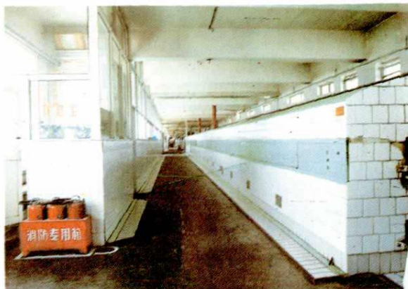
1983年，太原市食品三厂摇摆式饼干生产线，通过技改后，年产量由原来的2000吨提高到3500吨
