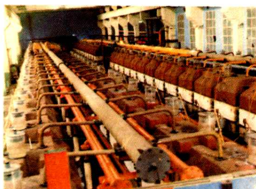
太原化工厂的新型虎克—20型立式隔膜氯碱电解槽
