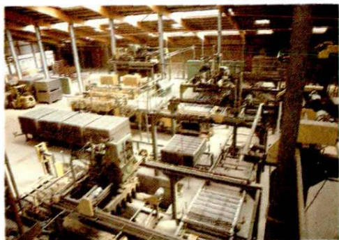
1986年，太原市建材总厂引进西德粘土空心砖生产线，经改造，年生产能力为7000万块砖
