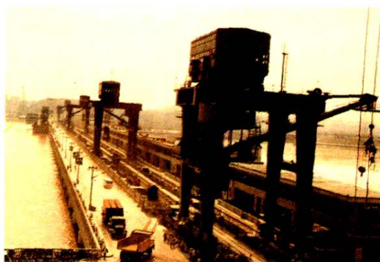
太原重型机器厂为葛州坝设计的 2 \times 250 吨门式起重机
