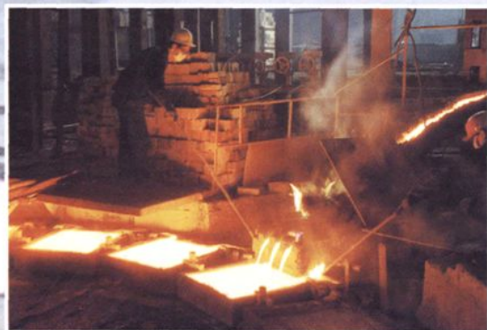
火法精炼系统圆盘浇铸机正在浇铸
