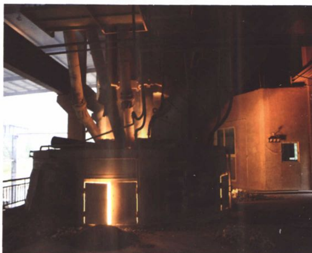
冶金（“倾旋式”精炼电炉）
