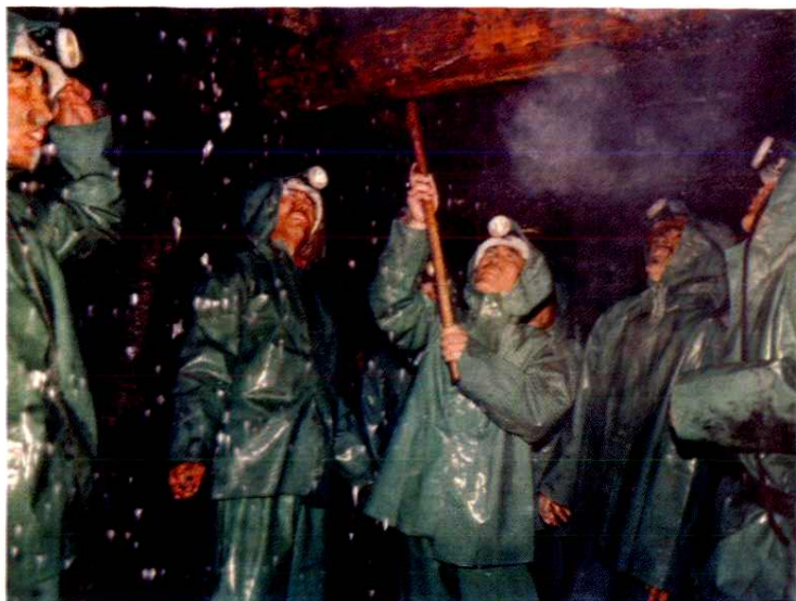
扎赉诺尔矿务局工人 在井下敲帮问顶
