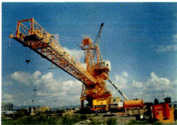
平庄矿务局元宝山露天矿从德国进口的挖掘机每小时挖掘能力为3600立方米，自重2700吨，是国内最大的轮斗挖掘机
