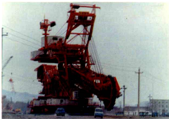
平庄矿务局元宝山露天矿从德国进口的挖掘机每小时挖掘能力为3600立方米，自重2700吨，是国内最大的轮斗挖掘机
