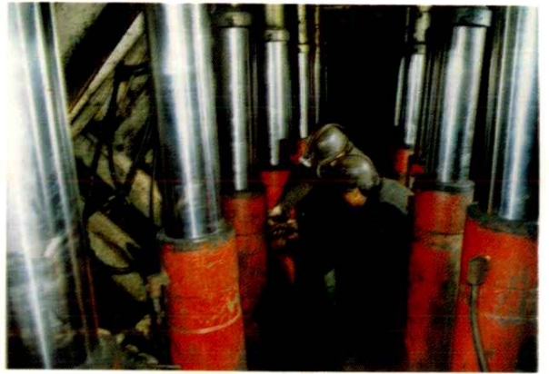
乌达矿务局黄白茨矿综采工作面正在移柱
