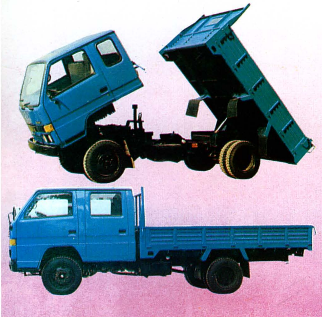
▲南宁手扶拖拉机厂制造的SY 双排平板 一排半自卸 农用运输车
