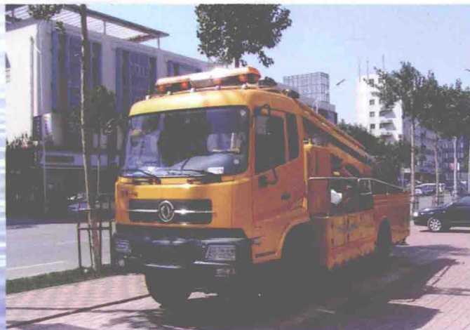
▲东丽区防汛物资储备的移动排水泵车（摄于2011年10月）
