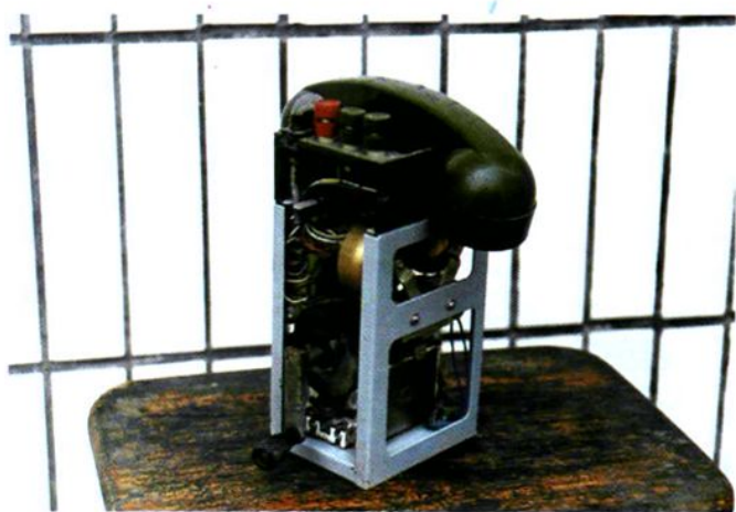
▲ ▼ 中华人民共和国成立前驻段线务员使用的磁石查线机
