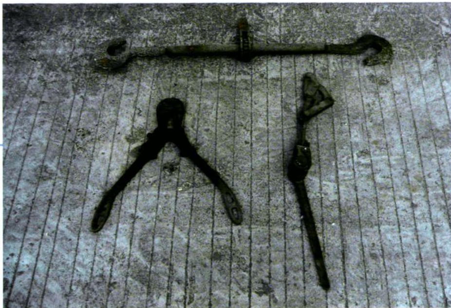
▲ 架线用的紧线钳、铝线压接钳和双钩
