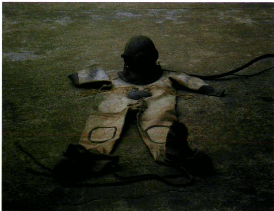
▲ 抢修水线用的潜水衣和充气泵。 ▼
