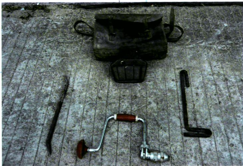
▲ 线务员使用的做拉线和打帮桩用的工具
