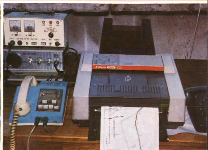
总调度室无线传真通讯系统
