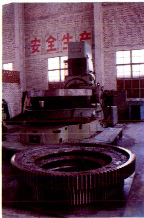
招远县黄金机修总厂、产品行销12个省市自治区。该厂的滚齿机可加工各种型号的大齿轮。图为机加工车间一角
