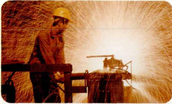
南昆线制梁场钢筋对接焊接操作。
