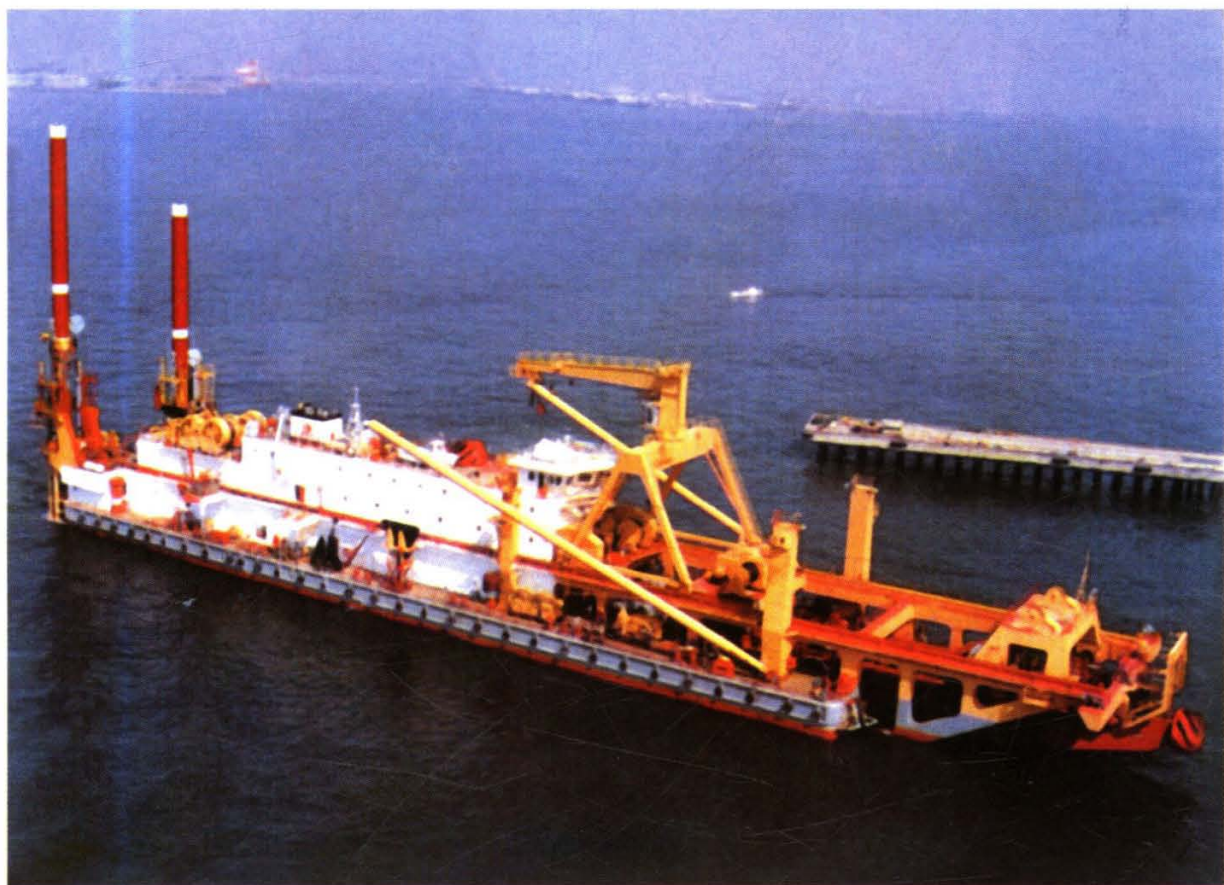
2500m 3 /h 绞吸挖泥船 —— “津航浚 215”
