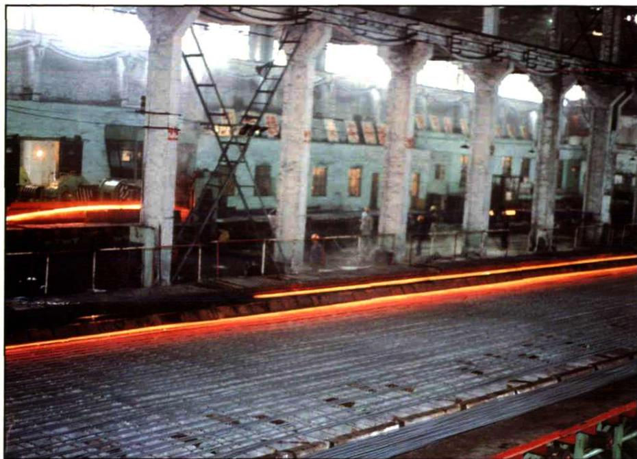
6 × 60 米步进齿条式机动冷床
