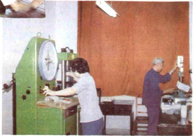
△ 厂化验室正在进行水泥出厂前物理检验。
