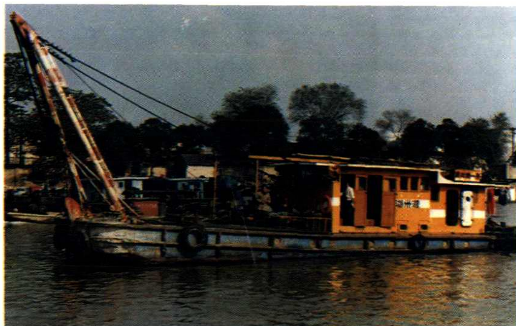
浙江省第一艘内河 25 吨自航式打捞船——“湖工捞 1 号”
