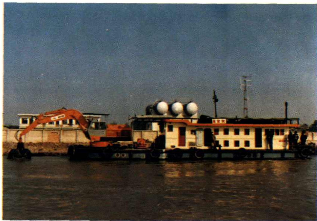
1m 3 全液压抓斗式挖泥船——“莱茵号”
