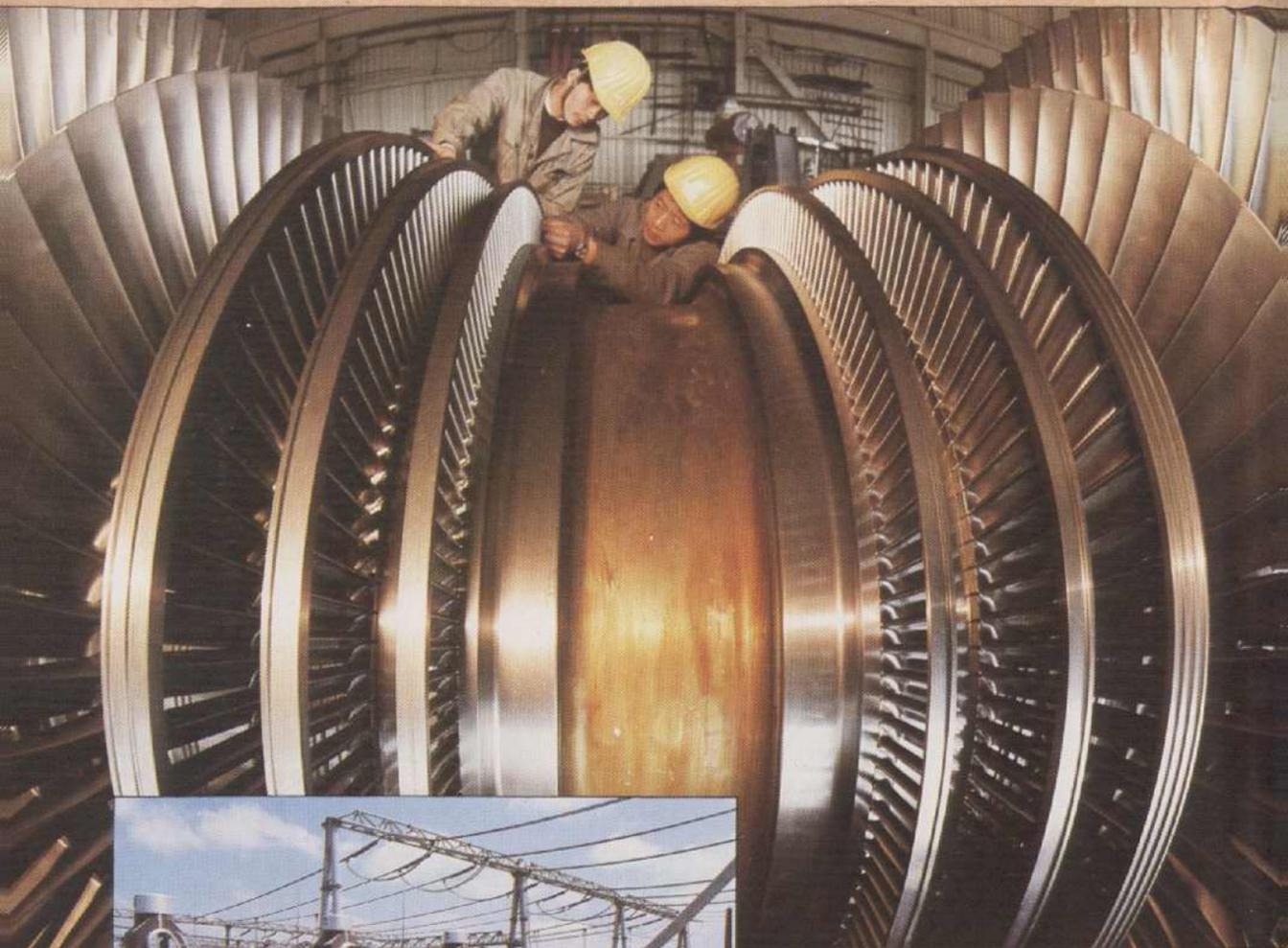
30万千瓦的汽轮机转子正在紧张安装
