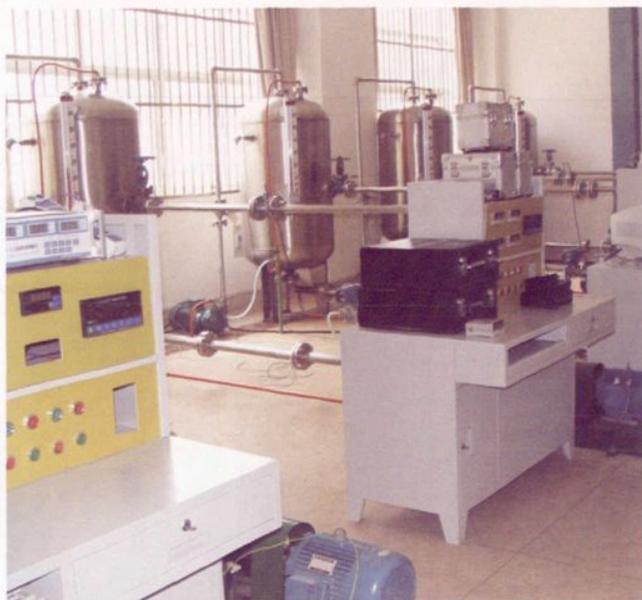
能源与动力工程学院自主研制的、国内唯一的小型水泵综合性能实验台
