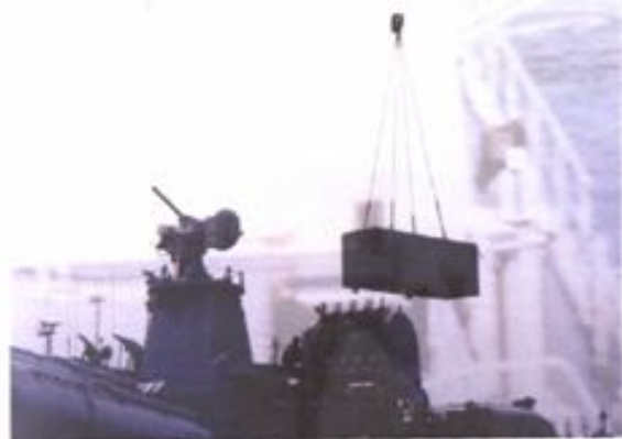
吊装导弹发射装置
