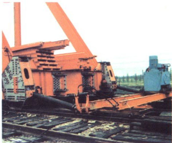
DTS型长跨钢桁梁架设顶推设备获铁道部科技进步二等奖
