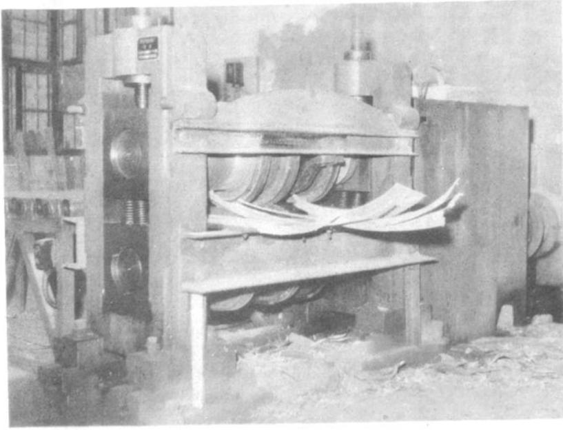
我厂自行设计制造的滚刀式剪板机
