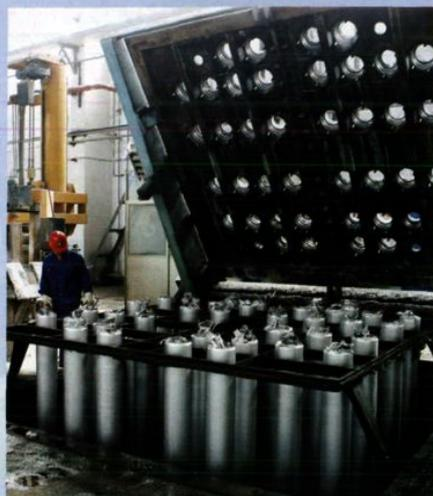
铝合金圆铸锭生产线
