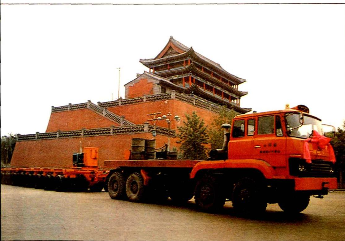
送变电公司自行设计改造的150吨平板拖车
