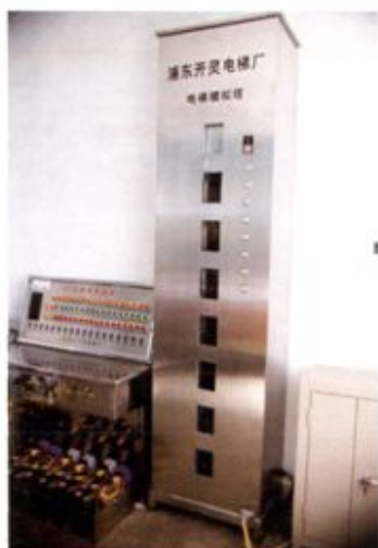
电梯性能测试模拟塔
