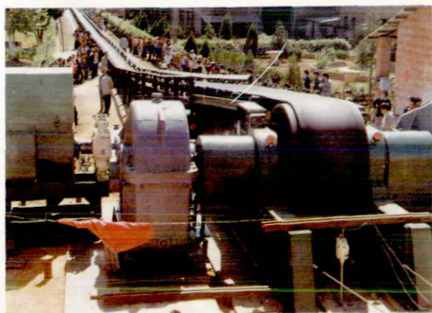
昆明煤矿机械总厂生产的 DX 钢绳芯带式 输送机
