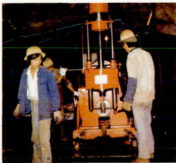
云南煤田地质队推广使用 TK 系列先进 钻机钻探
