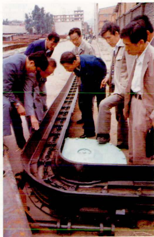
昆明煤矿机械总厂生产的可弯曲 90°刮板输送机
