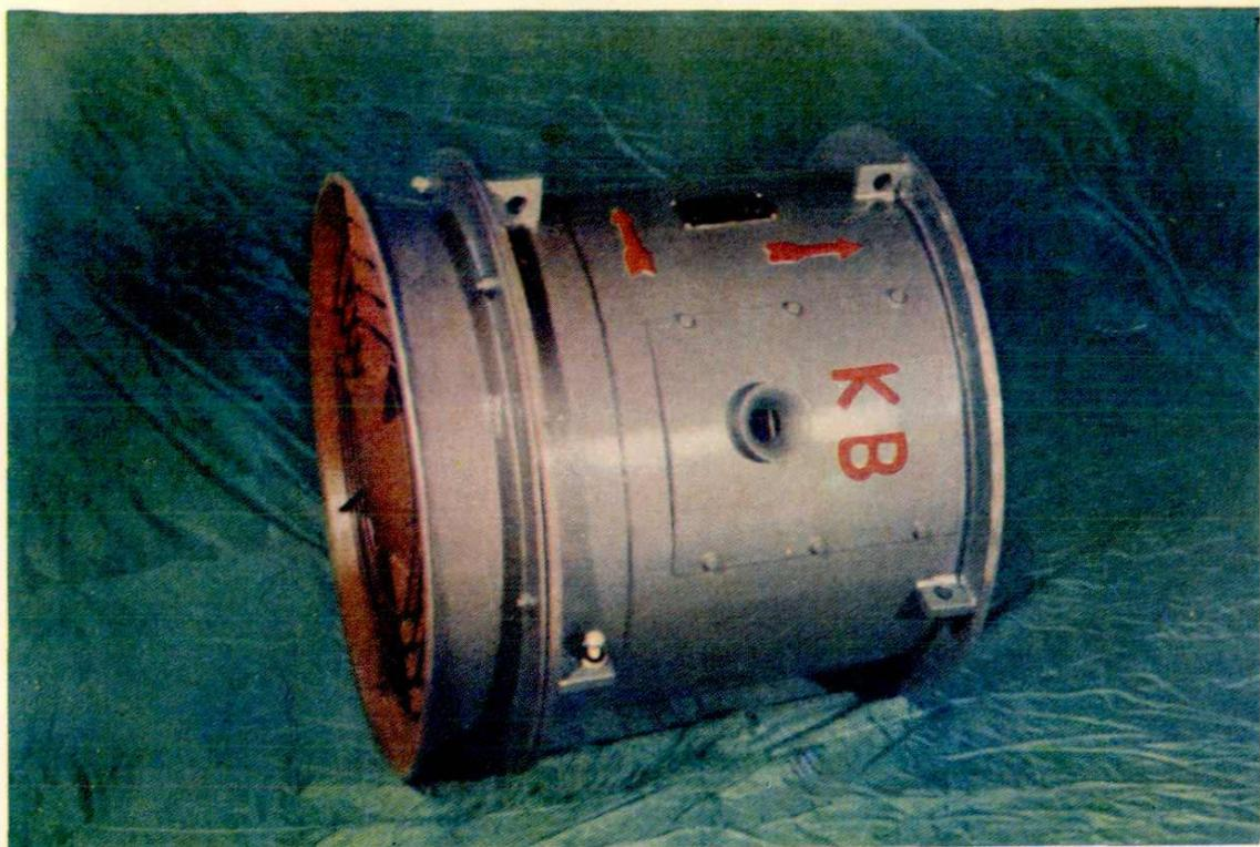
荣获机械工业部优质产品的JBT15#隔爆型轴流式局部扇风机
