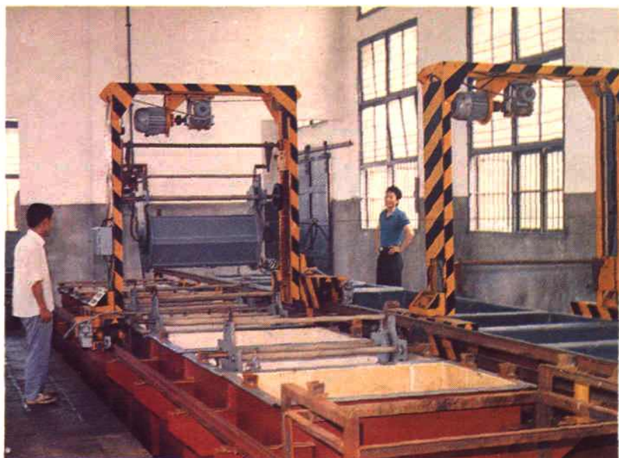
电镀车间工人师傅正在电镀自动化流水线上操作生产
