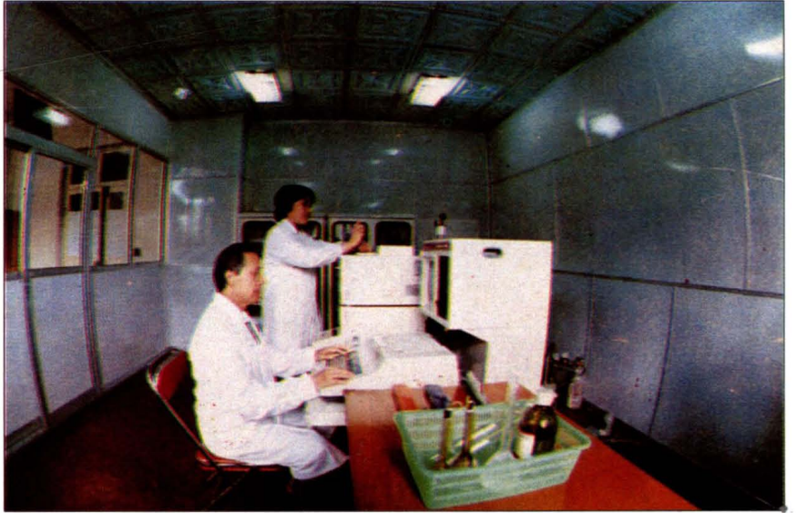
辽宁省卫生防疫站业务人员 应用质谱仪作大气检测
