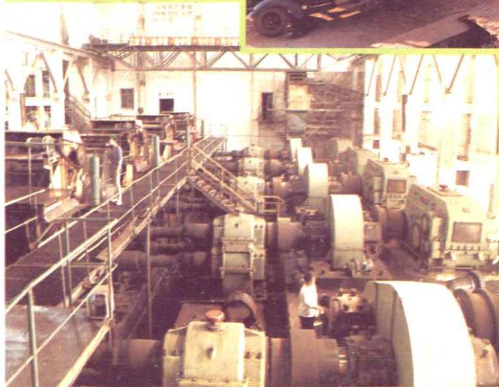
◁ 具有20世纪80年代世界先进水平的滚动轴承恒比压榨机
