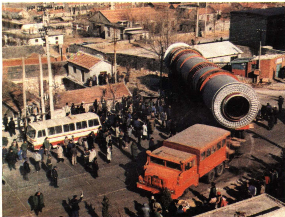
连云港市运输公司在装 216吨锻烧炉
